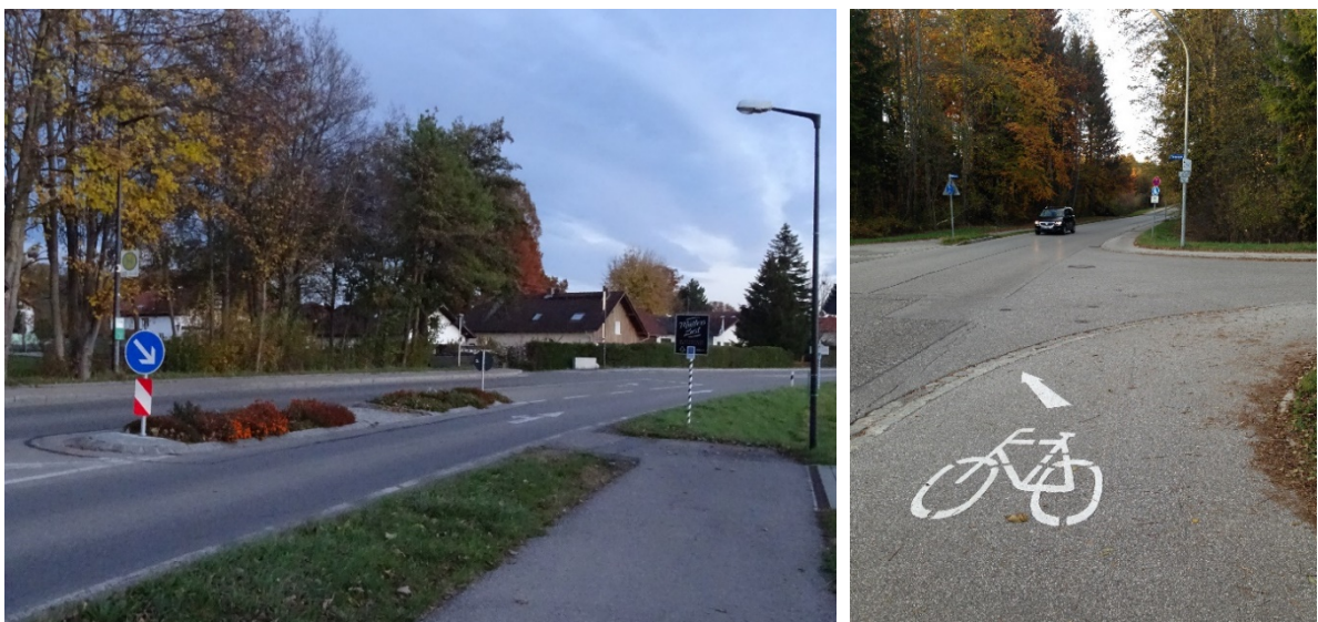
Abb. 33: Gesichertes Ende eines Radweges (links); Fehlende Überleitungen und Querungshilfen am Ende eines 2-Richtungsradweges. Zusätzliches Sicherheitsrisiko bei Kombination mit einer Kreuzung (rechts)
