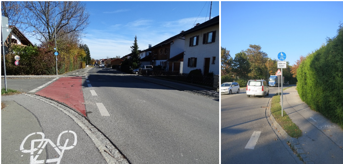
Abb. 32: Stark eingeschränkte Sicht an Kreuzungen und Einfahrten durch Bewuchs
