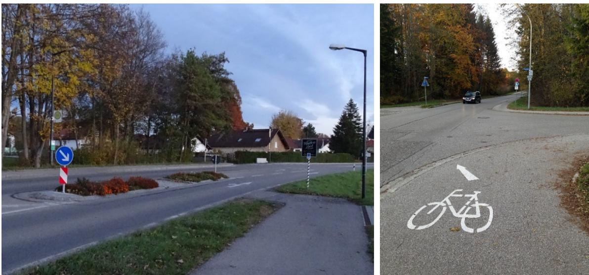
Abb. 33: Gesichertes Ende eines Radweges (links); Fehlende Überleitungen und Querungshilfen am Ende eines 2-Richtungsrads. Zusätzliches Sicherheitsrisiko bei Kombination mit einer Kreuzung (rechts)
