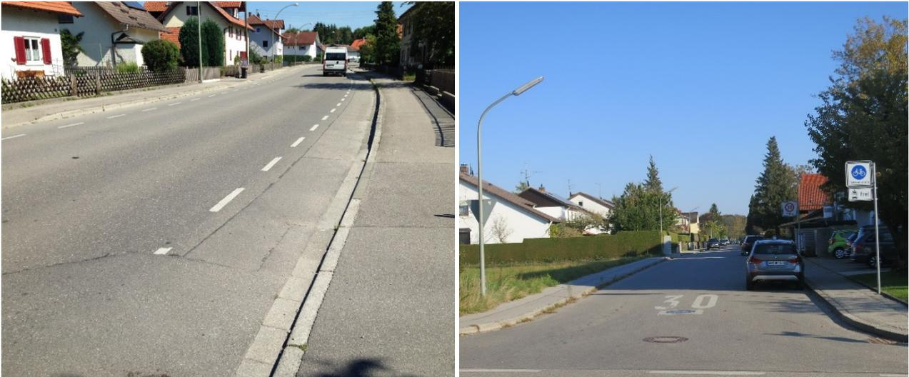
Abb. 15: Gesicherte Radverkehrsführungen Schutzstreifen (links); Fahrradstraße (rechts)
